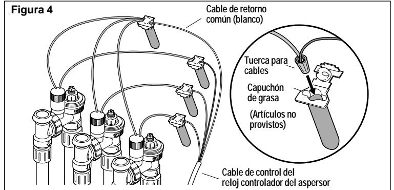
un cable separado codificado por color. Tome nota del color del cable usado para cada válvula para que le sirva de referencia cuando lo conecte al reloj controlador del aspersor. Vea la **Figura 4**.
