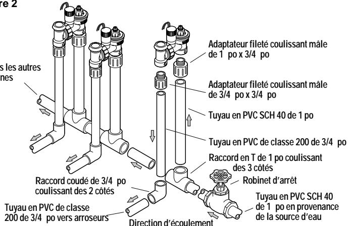
**Attention : Rincer la canalisation d'alimentation en eau à fond avant d'installer les vannes ! Si il y a du sable et des saletés dans la canalisation, la vanne risque d'être endommagée et/ou de ne pas fonctionner correctement.**
