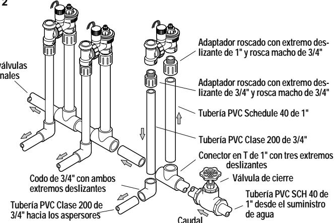
**Precaución:** ¡Enjuague completamente la tubería de suministro de agua antes de instalar las válvulas! La arena y la suciedad en la tubería pueden dañar las válvulas y/o impedir que funcionen correctamente.
