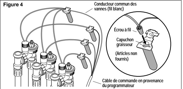
3. Au programmeur, brancher le fil commun blanc à la borne de sortie marquée "C" ou "COM". Connecter chaque fil de vanne chromocodé à la borne numérotée dans l'ordre de fonctionnement requis pour les vannes pendant un cycle d'arrosage. Pour obtenir plus de renseignements à ce sujet, consulter les directives d'installation qui accompagnent le programmeur.
